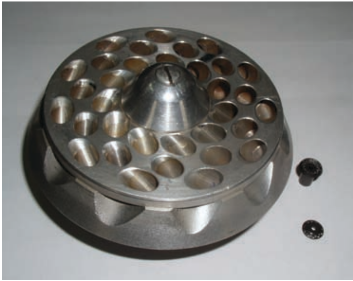
Элементы модели микрогазотурбинного двигателя в десятки раз больше оригиналов Elements of micro gas engine mock-up are tenfold bigger than original details
