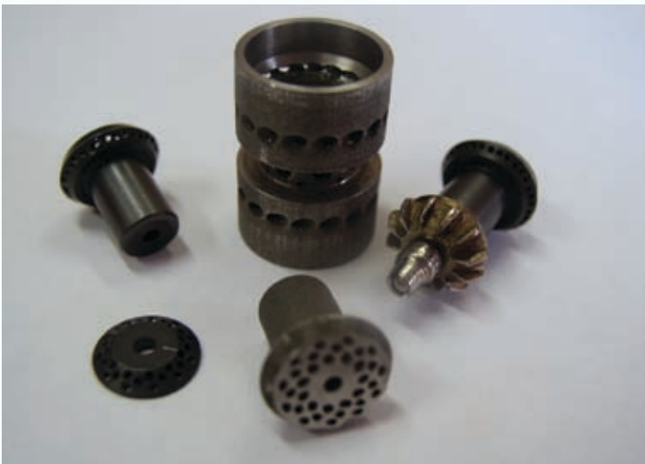
Экспериментальная турбина микрогазотурбинного двигателя (200 Вт) Gas micro engine experimental turbine (200 watt)
